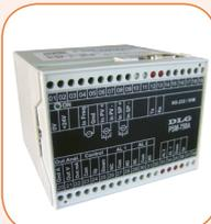
Posicionador para control de la rotación de turbina de vapor. Posiciona actuadores (servomotor) por control de "paso" (step) sin necesidad de realimentación de su posición, eliminando TEP (transmisor electrónico de posición) y potenciómetros. Posee varias funciones, como la protección de sobre velocidad ("trip"), el tiempo atracción del regulador, etc.
