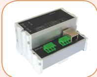
Los equipos y LME-200 y LME-210 son modernos y eficaces gateways que promueven la comunicación de datos entre las redes digitales Ethernet y Modbus RTU
