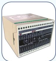
Convertidor / Distribuidor de señales con aislamiento galvánico y sincronismo. Opcional con ajuste de ganancia de entrada por potenciómetro y ajuste de relación de sincronismo por potenciómetro individual de salida. Entrada disponible para operación local (potenciómetro o remota - entrada analógica) con acción "bump-less".
