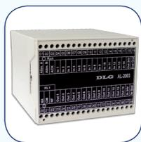
Anunciador de Alarma con secuencia de acuerdo al ISA.4A con 14 canales. Cada canal tiene una entrada (PNP o NPN). Salida a transistor (PNP o NPN) para señalización con lámpara o LED señalero 24 VCC y corriente máxima de 0,1 A. También posee fuente interna de 24 Vcc, 0,28 A para la Alimentación de la señalización
